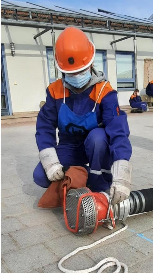
WTM befestigt die Ventilleine am dafür vorgesehenen Punkt und legt die Ventilleine neben der Pumpe ab
