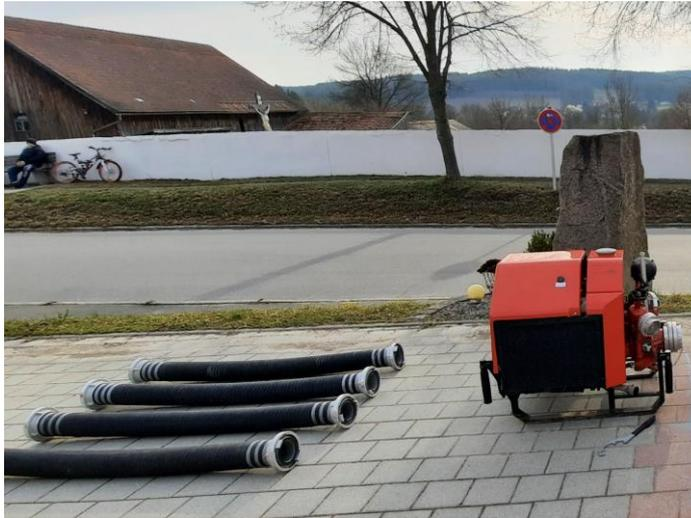
4 Saugschläuche liegen hinter der Pumpe bereit
