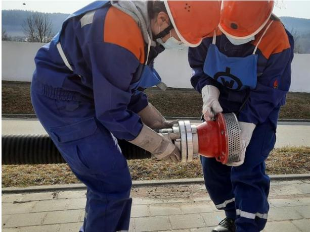
WTF und WTM koppeln den Saugkorb an den ersten Saugschlauch
